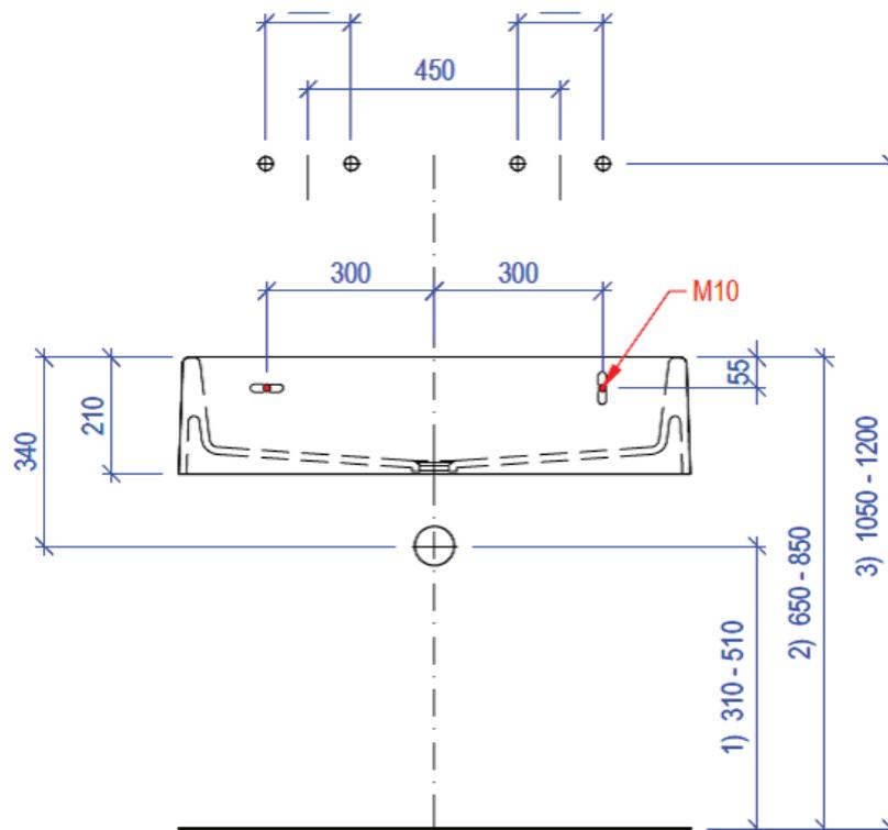
Ablauf / Überlauf: Standardmässig 1½" Ablaufventil mit Standrohr. Wird fertig eingebaut geliefert.
