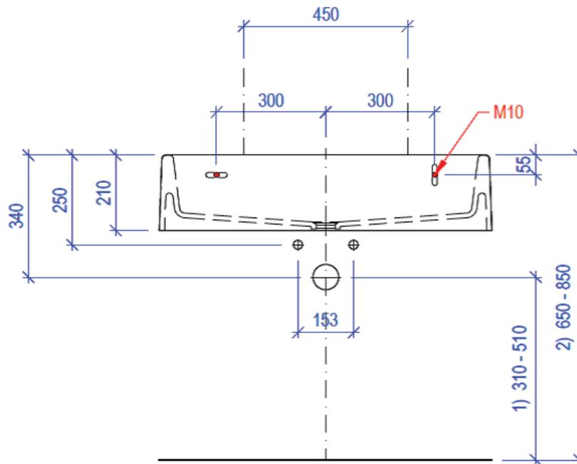
Ablauf / Überlauf: Standardmässig 1½" Ablaufventil mit Standrohr. Wird fertig eingebaut geliefert.
